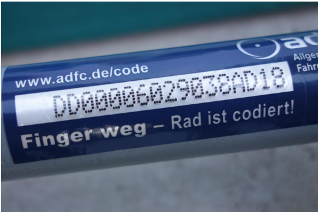
Bei der Fahrradcodierung werden Angaben über den Besitzer verschlüsselt am Rahmen angebracht
