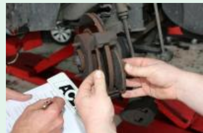
Bei diesem Mietwagen ist der Bremsbelag bis auf die Trägerplatte abgefahren
